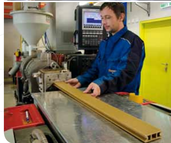
Wood-Polymer-Composites: Forschung macht das Holz formbarer, das so wie Kunststoff z. B. im Extrusionsverfahren erzeugt werden kann
