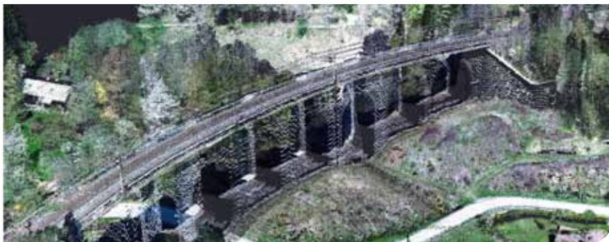
Hochauflösende Laserscans sind die Basis für die präzise Darstellung von Bahnstrecken in einer 3D-Karte
