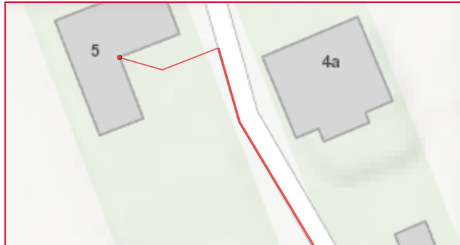
Abbildung 7: Zoom auf den Übergang von Feeder-Strecke auf Hausanschlussstrasse
