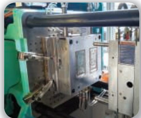
„Intelligentes“ Spritzgießwerkzeug zur Entwicklung des neuen Sensors sowie der Aktorik Elemente
