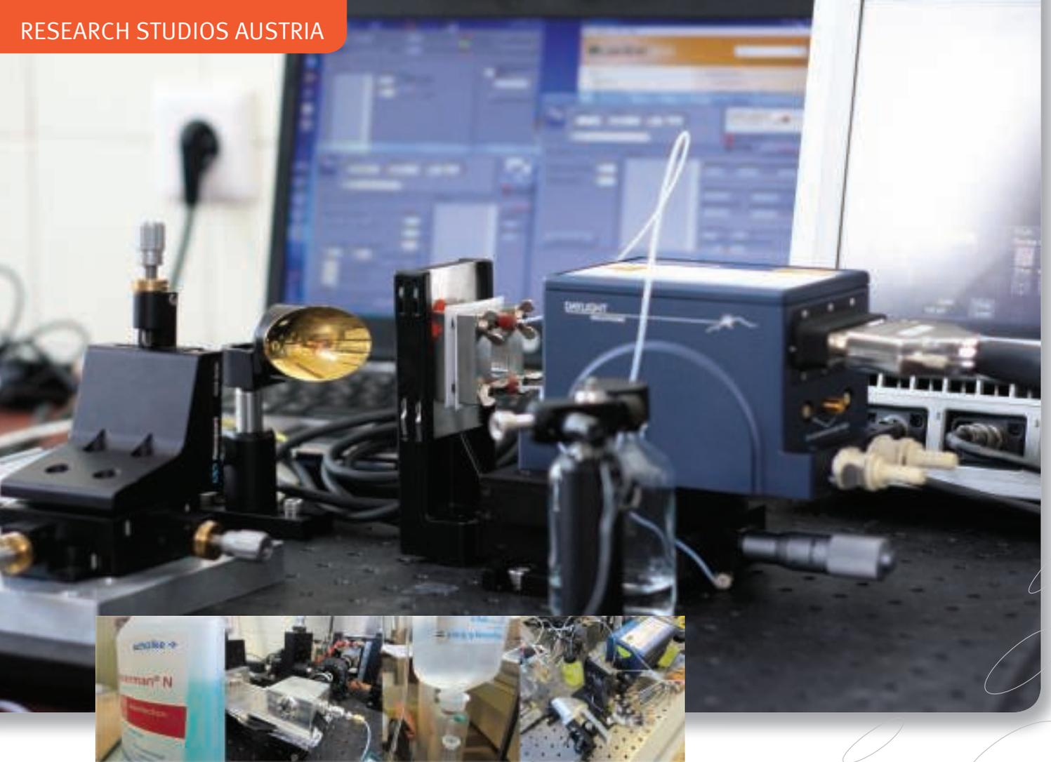
**Vibsense steht für „Vibrational Sensing“. Konkret geht es hier um die Messung von Molekülschwingungen für die chemische Analyse**
