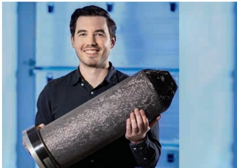
Stufen, die beim Flug in den Orbit nacheinander gezündet werden. Der Bauteil von Peak Technology befindet sich in Stufe Nummer zwei, die die Bezeichnung „Z 40“ trägt. Es handelt sich dabei um ein Zündgehäuse. „In dem Bauteil erfolgt die Zündung der ganzen Stufe mit ihren 36 Tonnen an Brennstoff“, erklärt Greinecker. „Das Gehäuse selbst ist mit einem Feststofftreibstoff gefüllt, der durch einen Elektroimpuls zur Zündung gebracht wird.“
