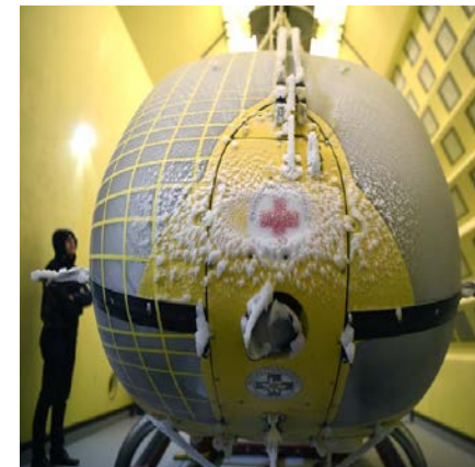
EC135 im Vereisungswindkanaltest im Rahmen von InTent-H (ohne Rotor)
