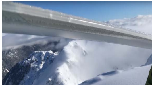
Beinahe-Crash durch Rotorblattvereisung
