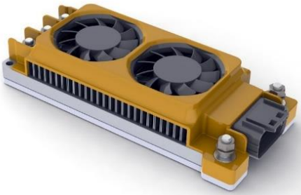
Abbildung 2: Kühlungskonzept aus dem ersten Versuchsträger
