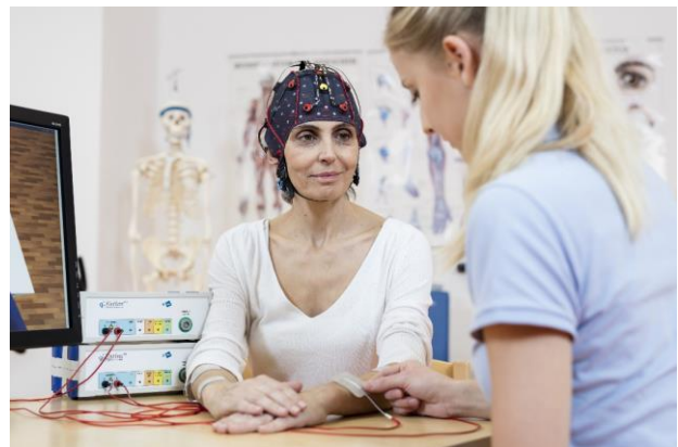
Abbildung: recoveriX ist eine moderne Gehirn-Computer Schnittstelle (Brain-Computer Interface), das die Gehirnaktivitäten der Patienten misst und in Echtzeit an den Computer sendet.
