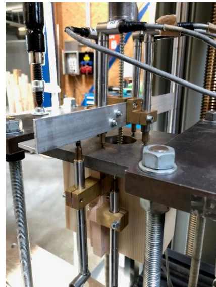
Abbildung 1: Prüf- und Messkonfiguration für den Einzelschraubenversuch
