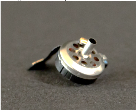
Abbildung 2: Auf der Abbildung sieht man den ersten, fertigen Prototyp des Dual-Lautsprechermoduls von USound.
