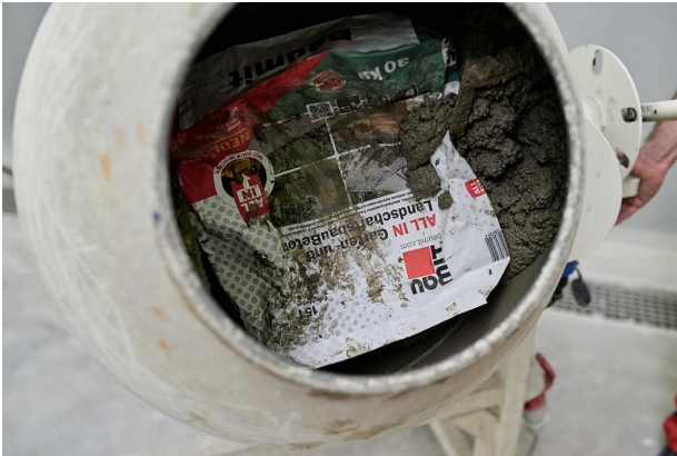
Abbildung 1: Bei der Baunit ALL IN Technologie wird der selbstauflösende Sack während des Mischvorganges Teil des Produkts.
