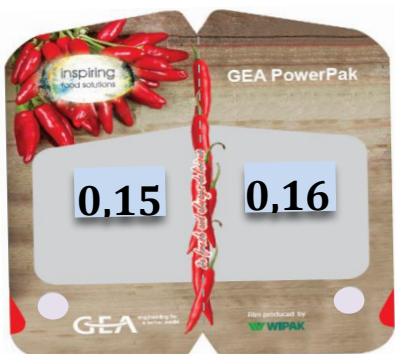
Abb.2: Lebensmittel Verpackungen mit Sensorspot und Darstellung des Rest-Sauerstoffgehaltes, der unter 0,5% betragen soll.
