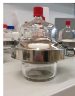
Abb.1: Aufbau und Bild „Migra-Cell“ zur simultanen Ermittlung der Migration aus der Probe, sowie der Barrierewirkung gegen Migration und Permeation durch die Probe (Foto: TU Graz, Grafik: FABES Forschungs-GmbH )
