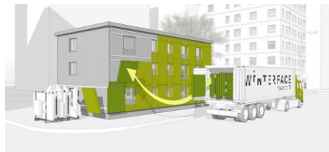
Abb. Produzieren in der Fabrikshalle, Montieren am Gebäudestandort
