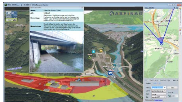
Abb. 1: Interaktive 3D-Visualisierungsszene, vollautomatisch aus einer Datenbank erzeugt. Basierend auf Vermessungs- und Planungs-Daten mit Links zu externen Dokumenten.
