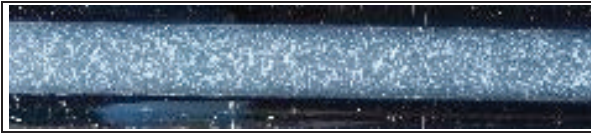
Abb. 1: Flocken eines ausgefällten Antikörpers, der kontinuierlich in einem tubulären Reaktor produziert wird
