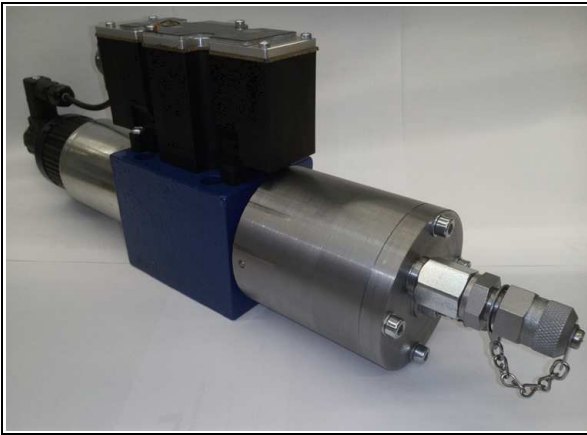
Bild 1: Ventilkraftsimulator auf einem Standardventil
