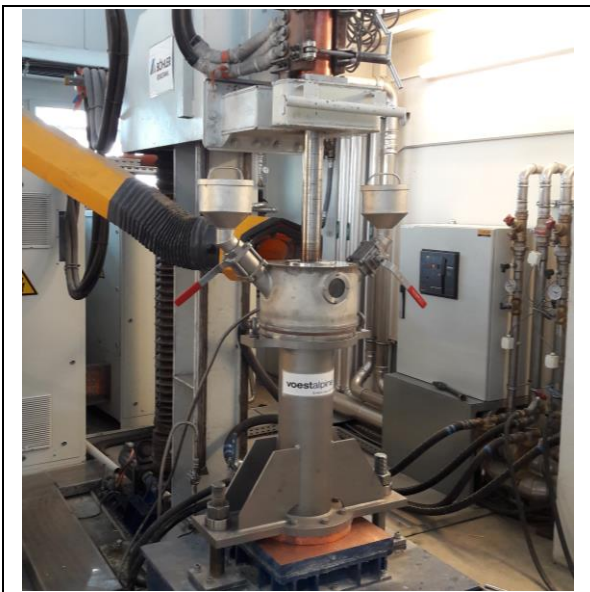
Abb. 1: Versuchs-ESU-Anlage mit neuer Kokille im Schutzgasbetrieb (Quelle: FH-OÖ-F&E GmbH, Wels)
