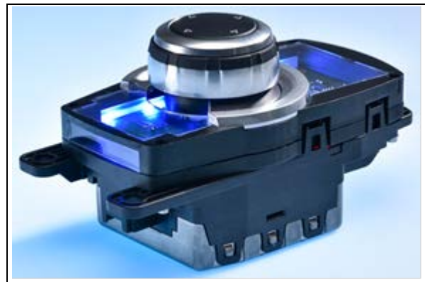
Abb. 2: Endgültige Version des Massendemonstrators durch Integration des entwickelten Magnet-systems in ein BMW iDrive Chassis.
