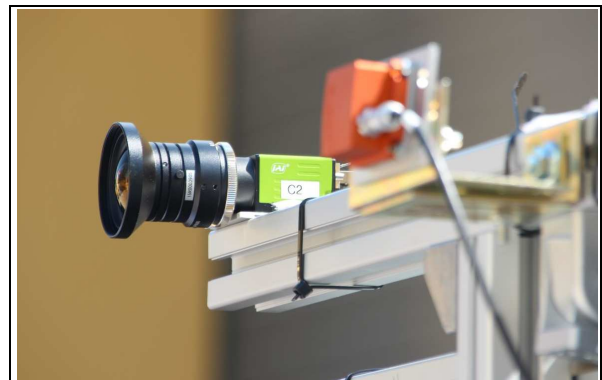
Abb. 1: Eine der beiden Kameras (grün) und Inertialsensormodul (orange), das genau zwischen den Kameras angeordnet ist. ( Foto: LCM).
