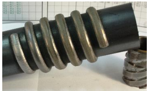
Abb. 1: Auftragung einer selbstschmierenden Beschichtung für Trockenanwendungen mit Reibungsreduktion (© AC2T research GmbH)
