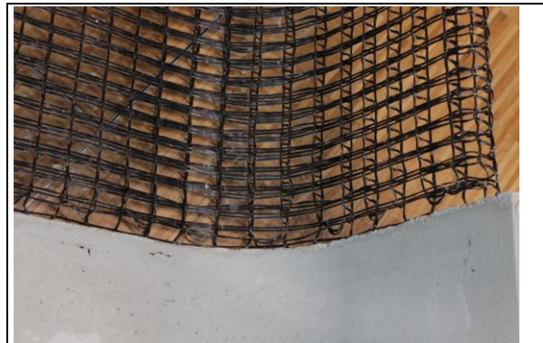
Abb. 2: Bewehrung und Textil-Betonteil (Copyright UIBK)
