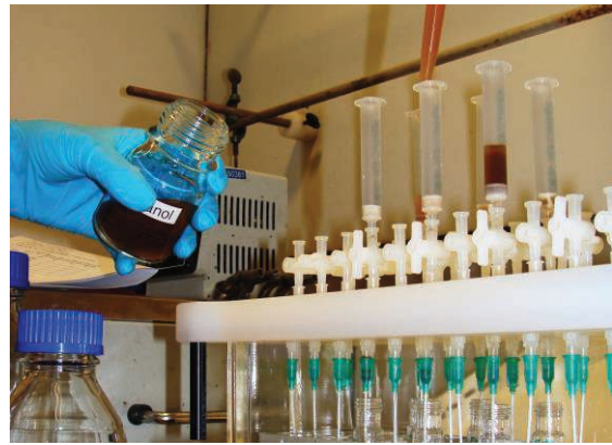
Abb. 1: Beladung der festen Phase mit einer Prozesswasserprobe
