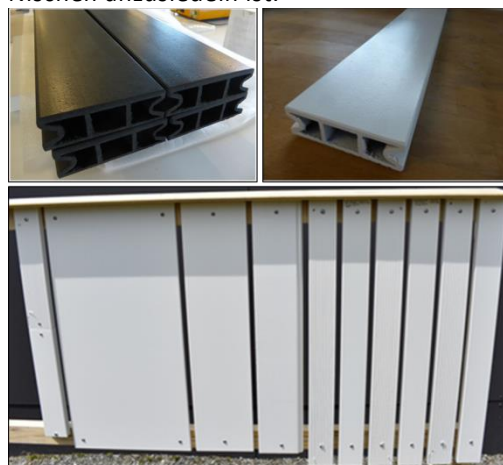
Abbildung oben: Modifizierte Holzpolymer-Profile unbehandelt (links) und pulverbeschichtet (rechts); Abbildung unten: Holzpolymer-Profile und außenbeständige Holzfaserplatten im Freibewitterungsstand (Versuchsfassade) (©Wood K plus)
