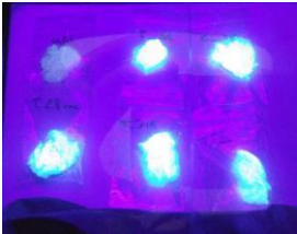
UV Licht Aufnahmen von optisch aufgehellten Viskoseproben nach 10s bei 210°C (©Wood K plus)
