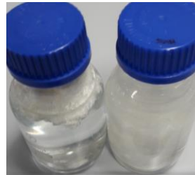
Links: Hydrophobierte stabile Faser, rechts unbehandelte Faser (©Wood K plus)
