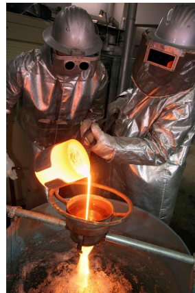
Wassergranulation im Schmelzlabor des FEhS - Institut für Baustoff-Forschung e.V.
