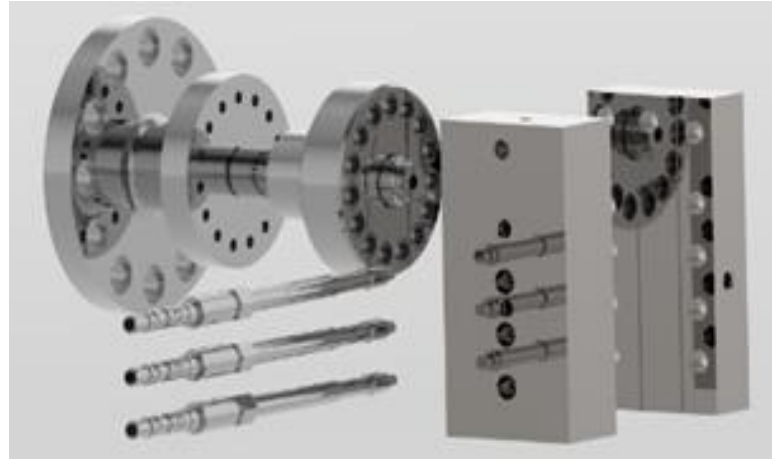
CAD-Modell der Rheologiedüse (© CHASE/Kastner)
