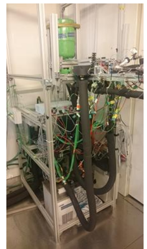
Eigens entwickelter Prüfstand zur Messung der Kältemittelverteilung
