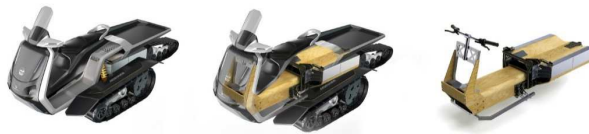
Quelle: MATTRO, Darstellung der Holzbauteile des Schneefahrzeuges "Ardenner"
