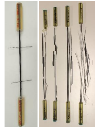
Abbildung 2: Zugprobe mit Messmarke (li) und gültige Versagensbilder (re)
