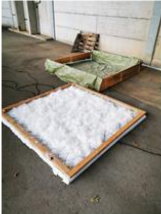
Abbildung 1: Viskosefasern sind auf dem Stahlgewebe verteilt, darunter befindet sich ein Viskosevlies
