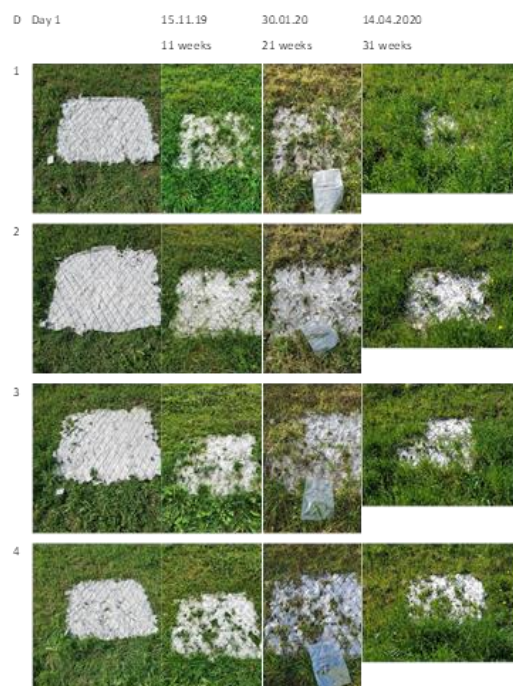
Abbildung 3: Feldversuche zum biologischen Abbau von Cellulosefasern in Geotextilien
