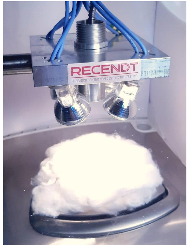
Laborsetup für Feuchtebestimmung mittels Nahinfrarot-Spektroskopie © RECENDT GmbH
