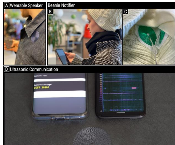
Abbildung 1: Es wurden drei verschiedene Demonstrator-Anwendungen entworfen und implementiert, darunter ein tragbarer Lautsprecher für einen Hand-Synthesizer (A), ein Beanie-Notifier (B, C) und ein Ultraschall-Kommunikator (D).
