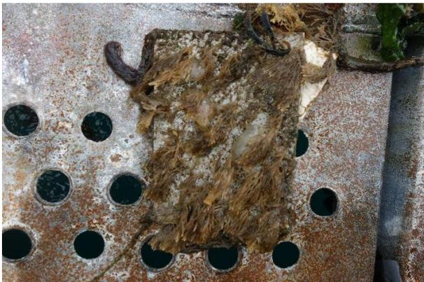
Abbildung 1: Beispiel Bewuchs auf einer Testplatte
