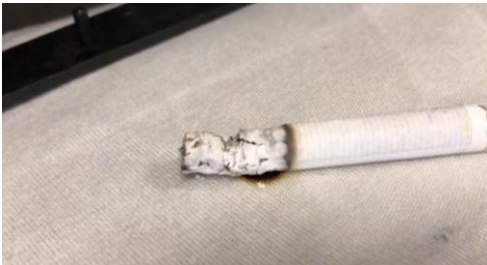
Figure 1. Horizontaler Brennversuch – Entzündungsquelle brennende Zigarette (Copyright Universität Innsbruck)
