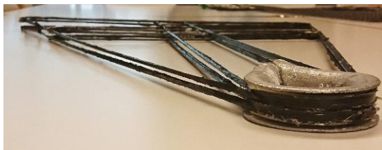
Abbildung 3: Verbesserte Transportschlaufen (Copyright University Innsbruck)
