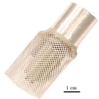
Der Ölkorrosivitäts-Sensor fungiert als zuverlässiges Vorwarnsystem und zeigt nötige Ölwechsel frühzeitig an
