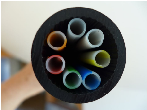
Abbildung 27: Kabelschutzrohr DA50 mit 7 Rohr-in-Rohr Mikrorohren 10 x 1mm
