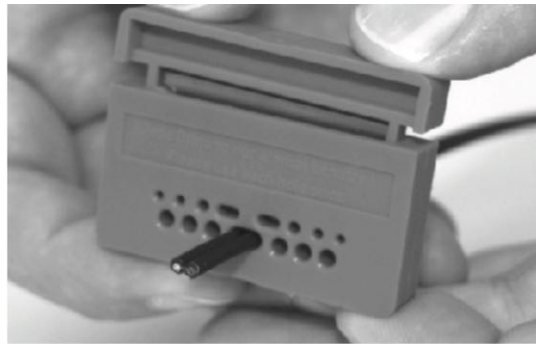
Abbildung 30: POF-Kabel mit Schneidewerkzeug
