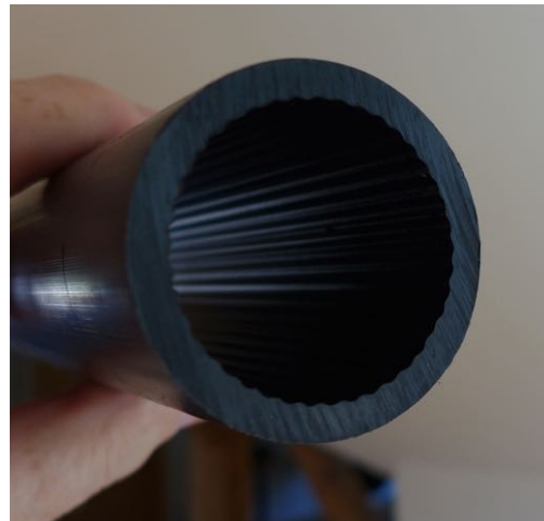
Abbildung 7: Kabelschutzrohr aus PE-HD gerieft
