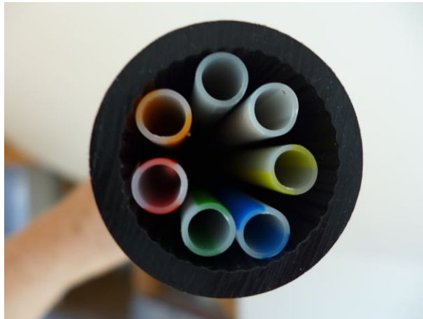
Abbildung 27: Kabelschutzrohr DA50 mit 7 Rohr-in-Rohr Mikrorohren 10 x 1mm
