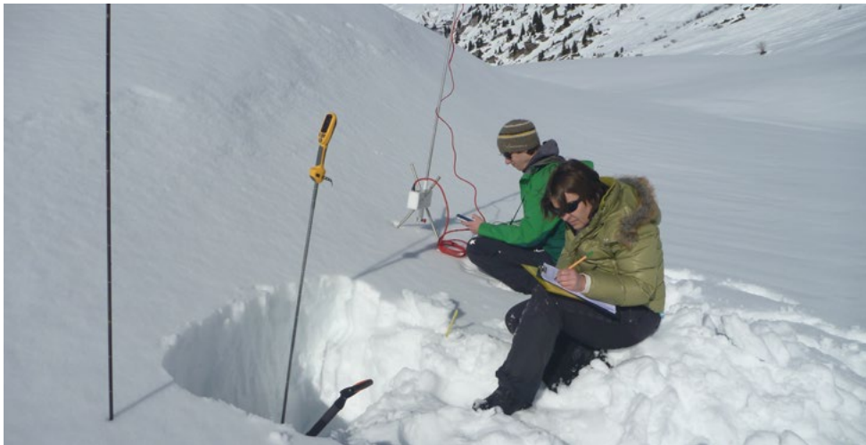
Feldtests verschiedener Messroutinen zur Bestimmung der Schneehärte, Foto: BFW, Zechling, 2017
