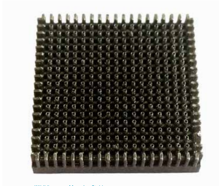
Kühlkörper aus Maraging Stahl für Heat-Management mit 500 µm Stegbreite und 350 µm Kanaldurchmesser.
