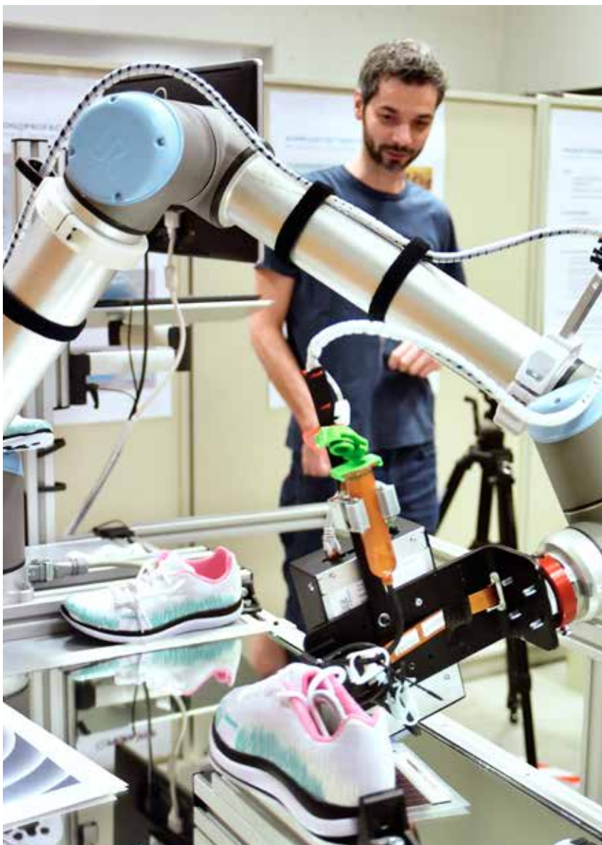
InkJet-Drucken mittels Roboter – Laboraufbau bei PROFACTOR
