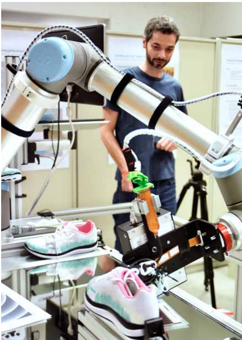
InkJet-Drucken mittels Roboter – Laboraufbau bei PROFACTOR
